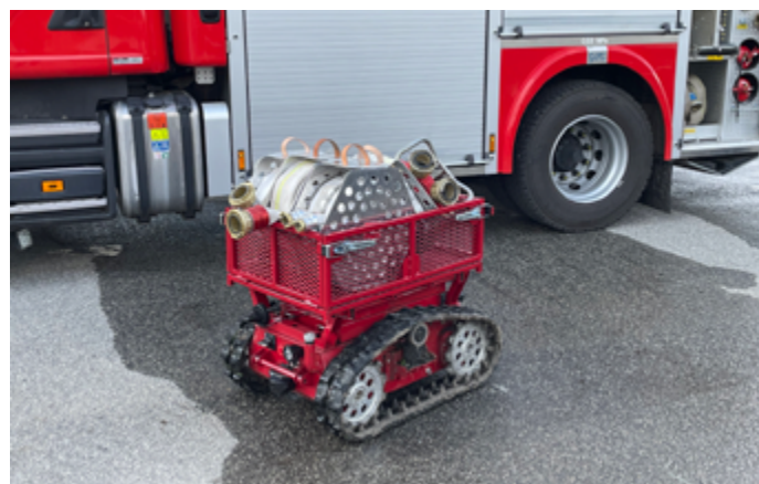
7. Fumo redo för utläggning av brandslang.
